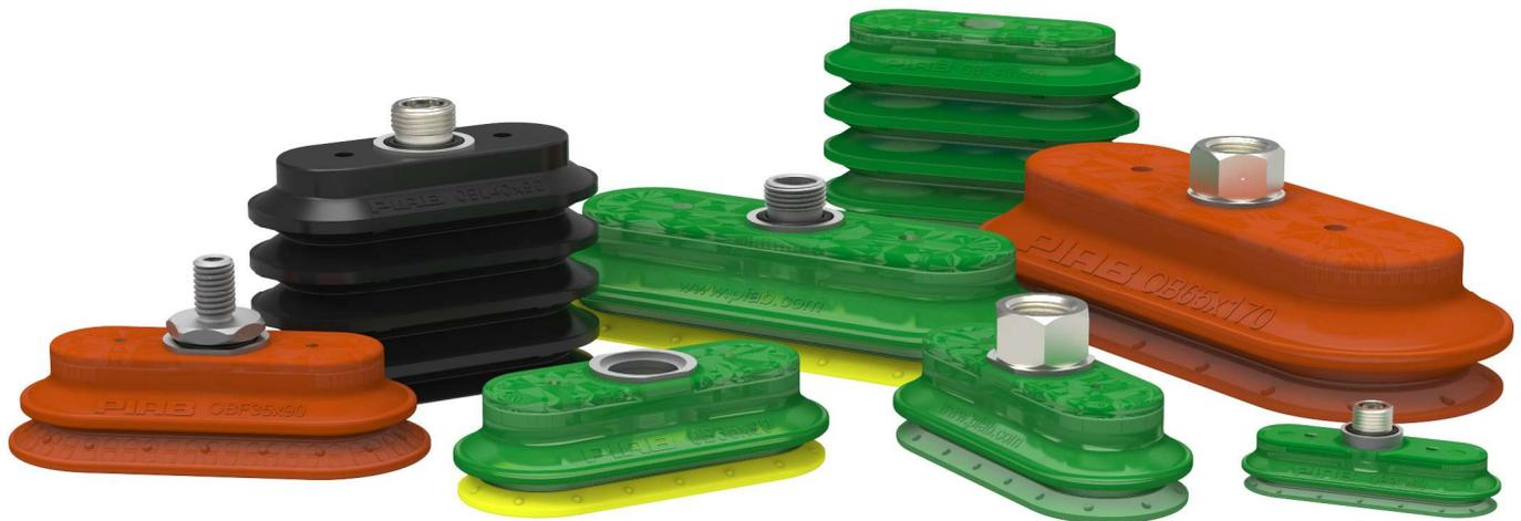
Ovale Saugnapfe sind besonders für die Handhabung von langen und schmalen Gegenständen und deren Oberflächen geeignet, wenn maximale anhebende Kraft gewünscht wird. Ovale Saugnapfe mit Balg sind besonders für unregelmäßige Oberflächen geeignet und wenn ein Höhenausgleich gewünscht wird. Die ovalen Saugnapfe in diesem Produktprogramm besitzen Eigenschaften, die besonders für das Blechhandling geeignet sind.
