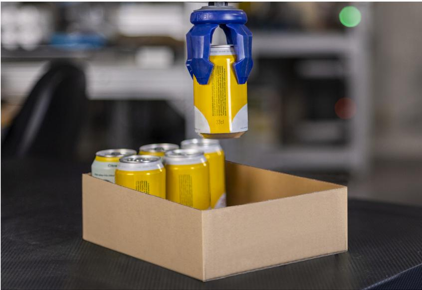
Piab stellt mit stolz sein neuestes und größtes Greifwerkzeug vor, den piSOFTGRIP® 100-4, der speziell für die Automatisierung in der Lebensmittelindustrie entwickelt wurde. Er ist auch in der Lage, ungewöhnlich geformte Maschinenteile aufzunehmen oder Spritzgussteile zu entfernen.
