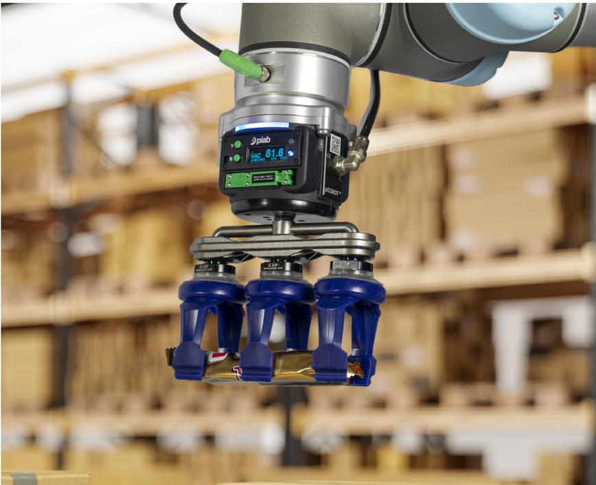
Der piSOFTGRIP® 50-2 eignet sich auch für Objekte mit einer Breite von 10 bis 50 mm (0,40 bis 1,97 Zoll). Auch dieser Greifer wurde mit Blick auf die Süßwarenindustrie und die Verpackung empfindlicher Objekte wie Schokoriegel oder mit Sahne gefüllte Waffeltüten entwickelt, eignet sich aber auch zum Verpacken von Fischstücken in Dosen.
