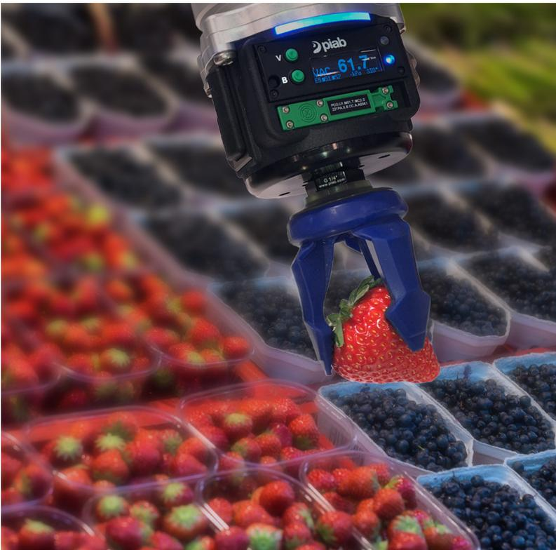
Kein Problem mit Piabs weichem Greifwerkzeug piSOFTGRIP® 50-3, das über drei dreieckige Greiffinger verfügt und Objekte mit einer Breite von bis zu 50 mm (1,97 Zoll) greifen kann. Der Greifer nimmt empfindliche und leichte Objekte mit ungewöhnlichen Geometrien, länglichen Formen und/oder ungewöhnlichen Oberflächen auf.
