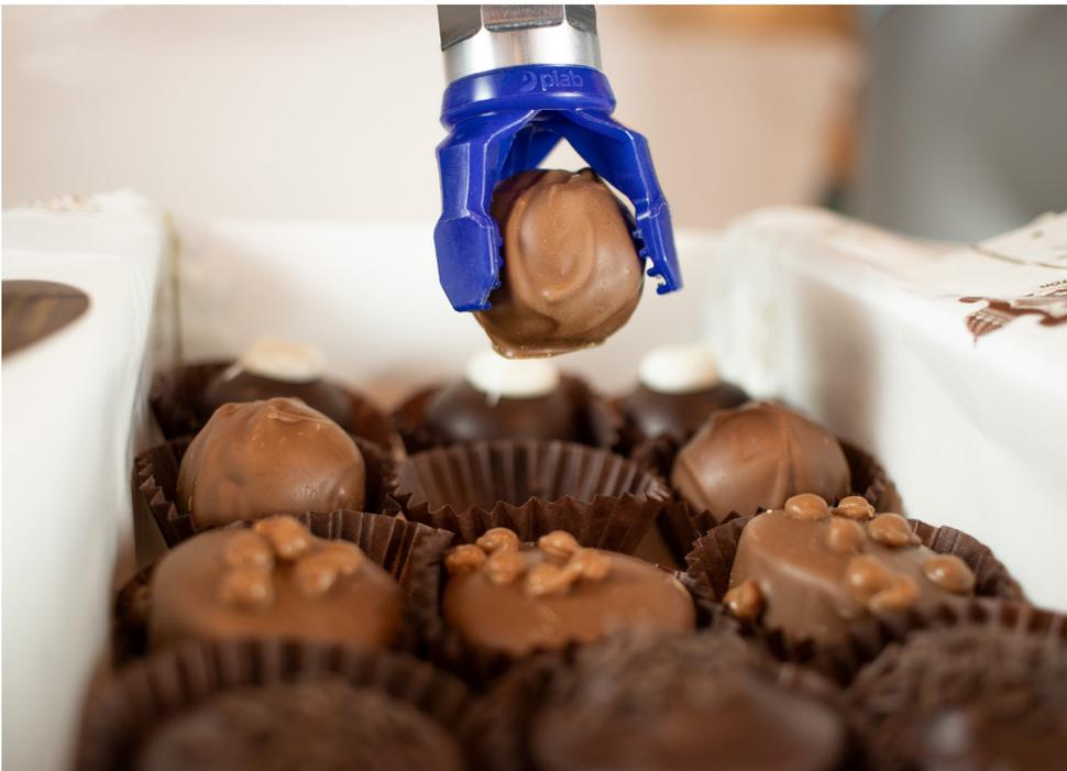
Piabs piSOFTGRIP® 30-3 hat drei ovale Greiferfinger mit tiefen Rillen und einem Vakuumraum. Er kann Objekte bis zu einer Breite von 30 mm (1,18 Zoll) aufnehmen und wurde ursprünglich für die Süßwarenindustrie entwickelt, um Pralinen automatisch zu bewegen.
